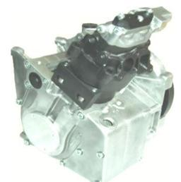
Von Günter Elsbett in 1988 konstruierter erster Range Extender, Einzylinder, Diesel-Direkteinspritzung, voller Massenausgleich, hydraulische Ventilsteuerung, Schwungrad zur Kurbelwelle höher übersetzt (wg. Gewichtsminderung für leichteren schneller drehenden Generator), Bohrung 82 mm, Hub 92 mm, Leistung 10 kW bei  $3600 \text{ min}^{-1}$ , Gewicht 44 kg
